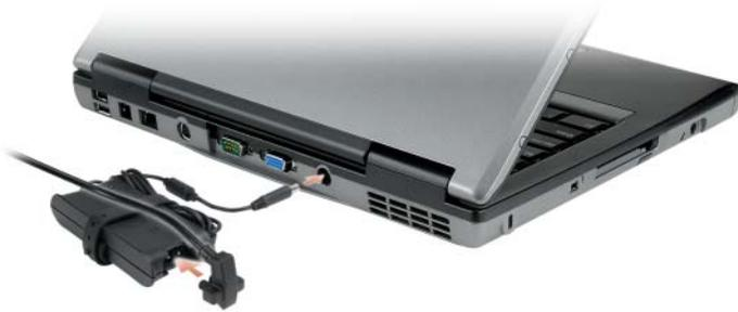
El adaptador de CA convierte la corriente alterna en la corriente continua que necesita el equipo. Puede conectar el adaptador de CA al equipo independientemente de que esté encendido o apagado.
